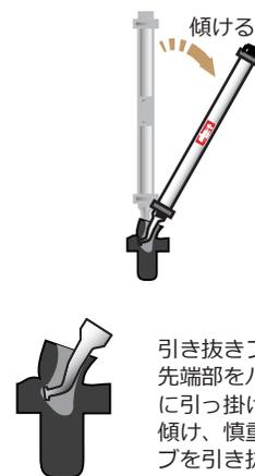
引き抜きフックの先端部をバルブ内に引っ掛ける様に傾け、慎重にバルブを引き抜く。
