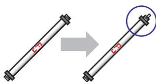
バルブ取替専用工具 (TL-40) の MIKASAロゴを正面にした**右側**のねじを外し、反転させて挿入ツールを取り付ける。
