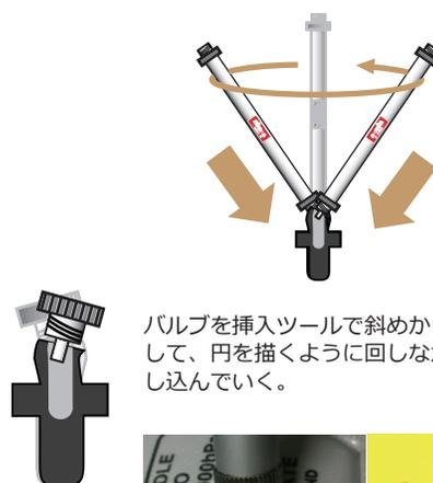
バルブを挿入ツールで斜めから押し込む様にして、円を描くように回しながらバルブを押し込んでいく。
