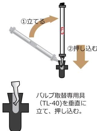
バルブ取替専用工具 (TL-40)を垂直に立て、押し込む。
