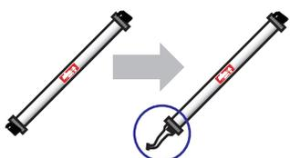
バルブ取替専用工具 (TL-40) の MIKASAロゴを正面にした**左側**のねじを外し、反転させて引き抜きフックを取り付ける。
